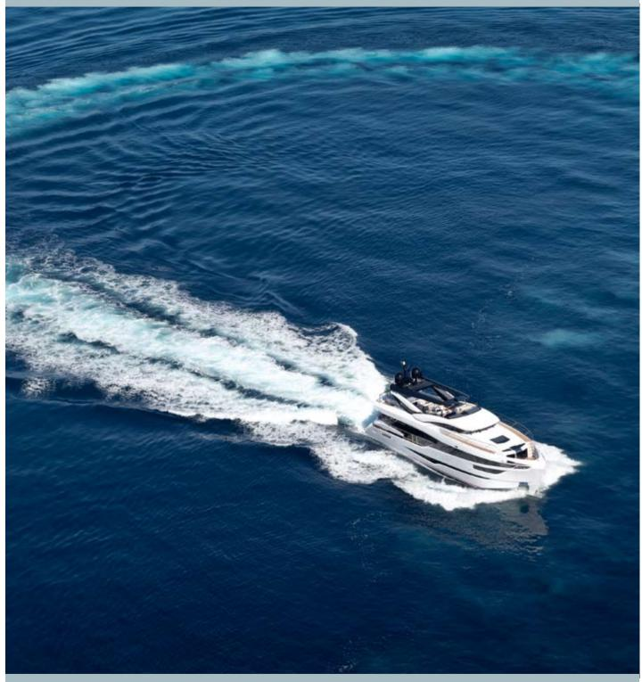
Длина 27,50 м Ширина 6,72 м Осадка 1,3 м Водоизмещение 69 т Двигатели 2 x 1 200 л.с. МАN V8 diesel Скорость макс. / крейс. 21 узел / 10 узлов Дальность хода на скорости 10 узлов
